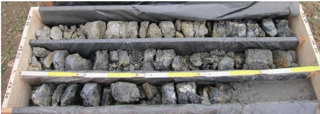
Abb. 2.1.1.24: EKB02a Wimpassing: 12,0-15,0m: Mitteltriassische schwarze Dolomite, teilweise stark geklüftet (Foto: M. Peresson).
