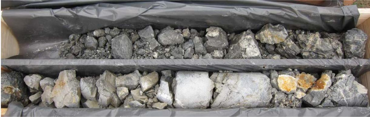
Abb. 2.1.1.26: EKB02a Wimpassing: 18,0-20,0m: Mitteltriassische schwarze Dolomite, teilweise stark geklüftet (Foto: M. Peresson).
