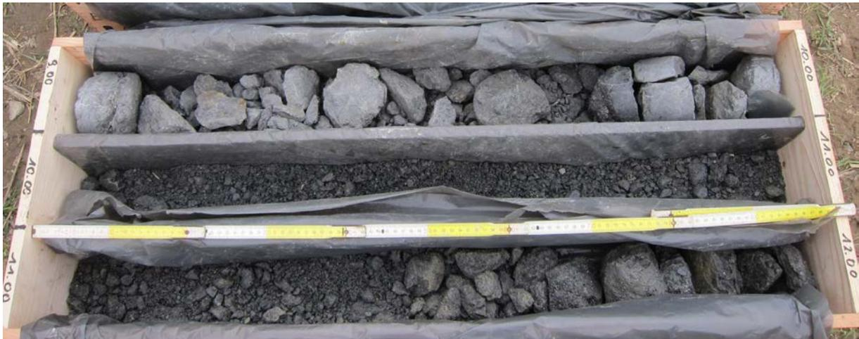
Abb. 2.1.1.23: EKB02a Wimpassing: 9,0-12,0m: Mitteltriassische schwarze Dolomite, teilweise stark geklüftet (Foto: M. Peresson).
