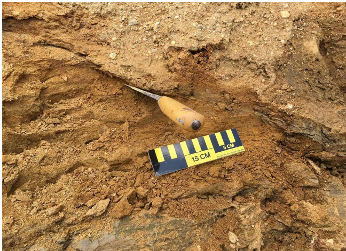
Abb. 2.2.1.59.: Baustelle entlang der B50 bei Oberwart: Aufschiebungsfläche (parallel zur Spachtel); Schichtung parallel zum Maßstab (Foto: M. Peresson).
