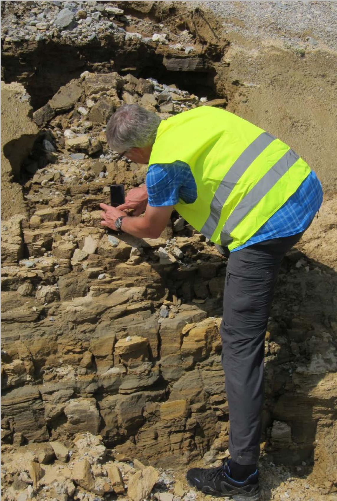
Abb. 2.2.1.36.: „Baulos Kriechspur B50 bei Oberwart“: Messen von Kluftrichtungen im Aufschluss (Foto: M. Peresson).
