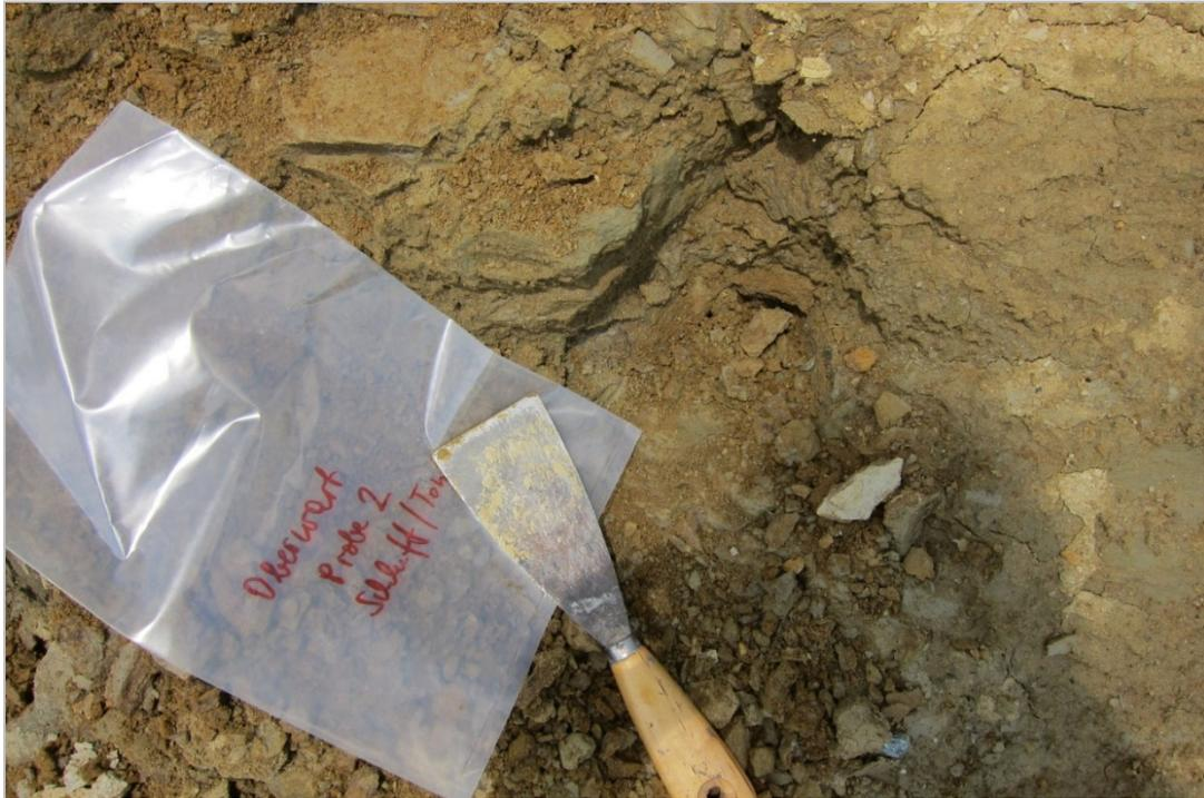
Abb. 2.2.1.13.: „Baulos Kriechspur B50 bei Oberwart“: Ungestörter Bereich am westlichen Startpunkt der Baustelle. Probenahmepunkt für die „Probe 2“ an der Basis der geschichteten Ablagerungen (Foto: M. Peresson).
