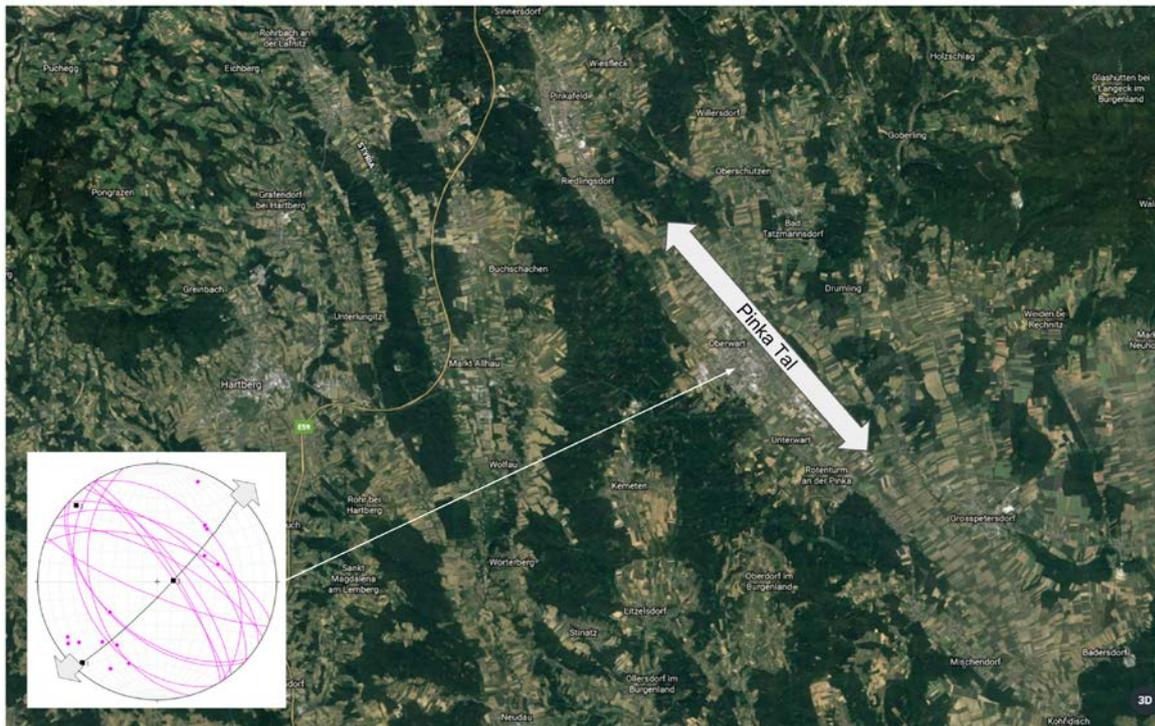
Abb. 2.2.1.69.: Die Morphologie im Oststeirischen Becken, sowie das Tal der Pinka weisen eine NW-SE streichende Topografie auf, die auffallend parallel zu den gemessenen Abschiebungsflächen verläuft und als Ausdruck dieses jungen bruchtektonischen Ereignisses interpretiert wird.
