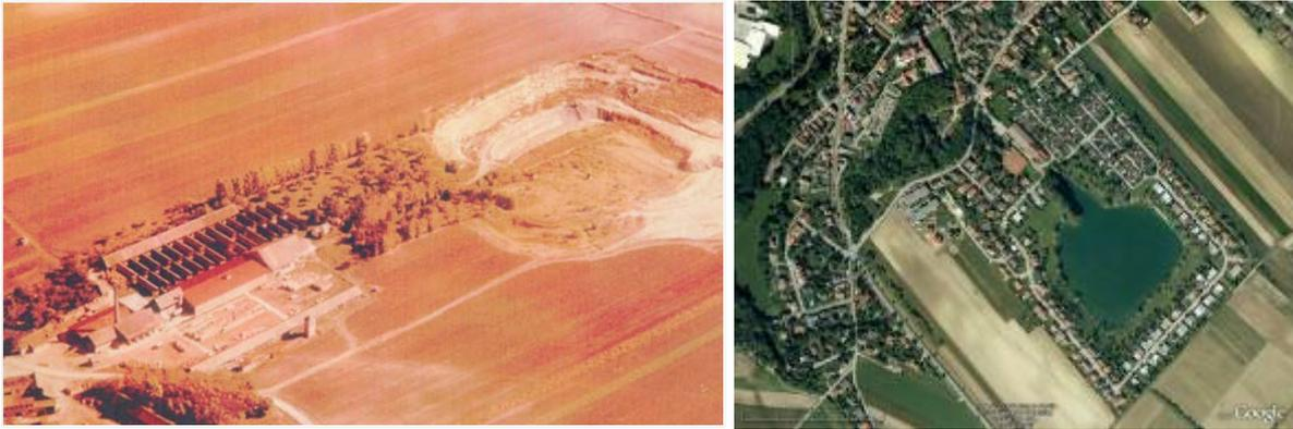
*Abb. 2.1.1.7: Aufnahme der ehemaligen Ziegelfabrik der Firma Johann Wimmer K.G. in Wimpassing aus dem Jahre 1960, die nach 1976 durch die Firma der Gebrüder Tschiedel in ein Freizeitzentrum umgewandelt wurde. Im linken Bild ist die ehemalige Abbaugrube zu sehen. Links unten steht der Ziegelbrennofen und daneben die Reihen überdachter Stapelplätze zur Freilufttrocknung der gepressten Ziegel (Reproduktion mit freundlicher Genehmigung durch Hans Tschiedel, Wimpassing).*
