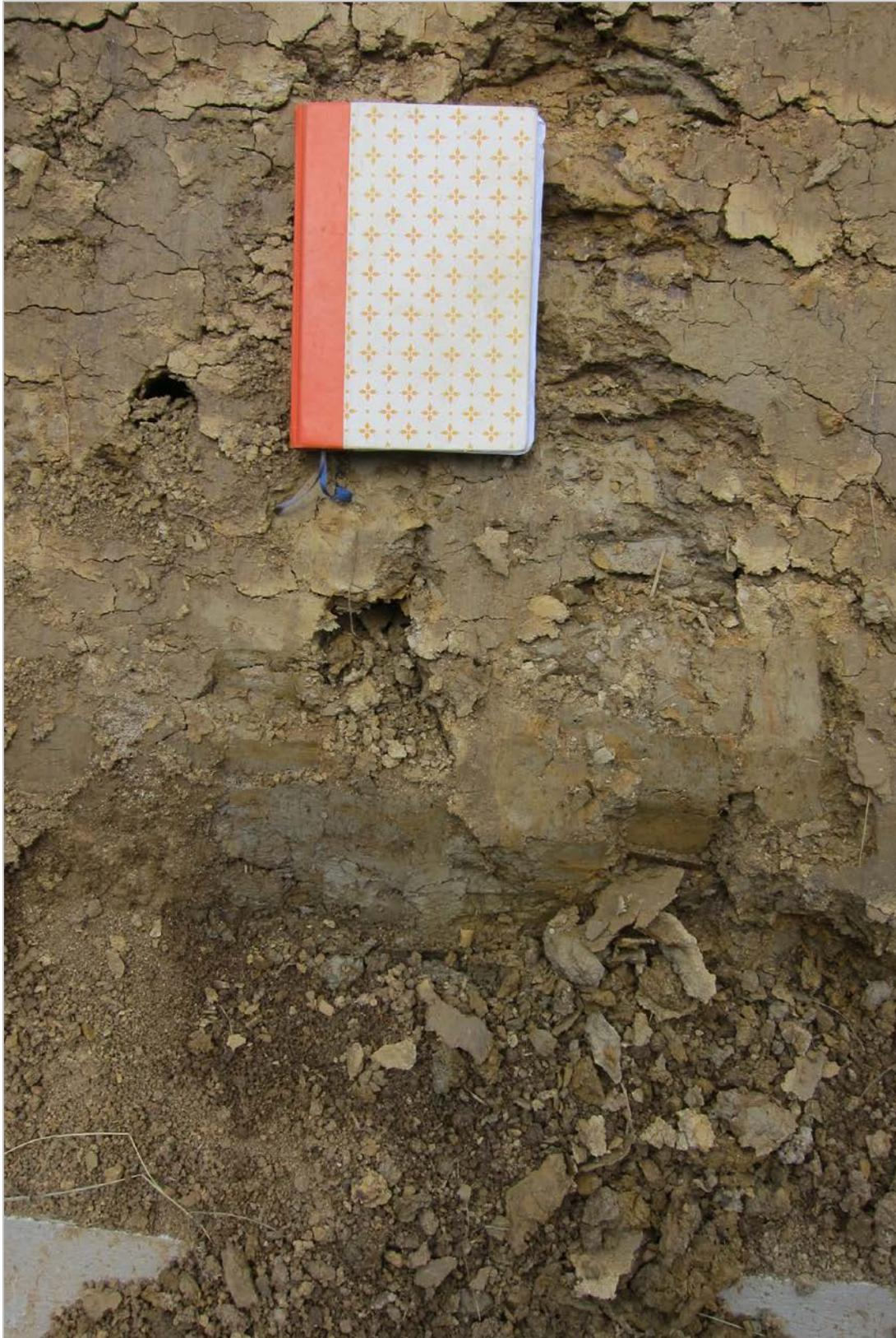
Abb. 2.2.1.12.: „Baulos Kriechspur B50 bei Oberwart“: Ungestörter Bereich am westlichen Startpunkt der Baustelle. Graue bis braune Farbgebung der tonigen Sedimente mit erkennbarer Schichtung an der Basis (Foto: M. Peresson).
