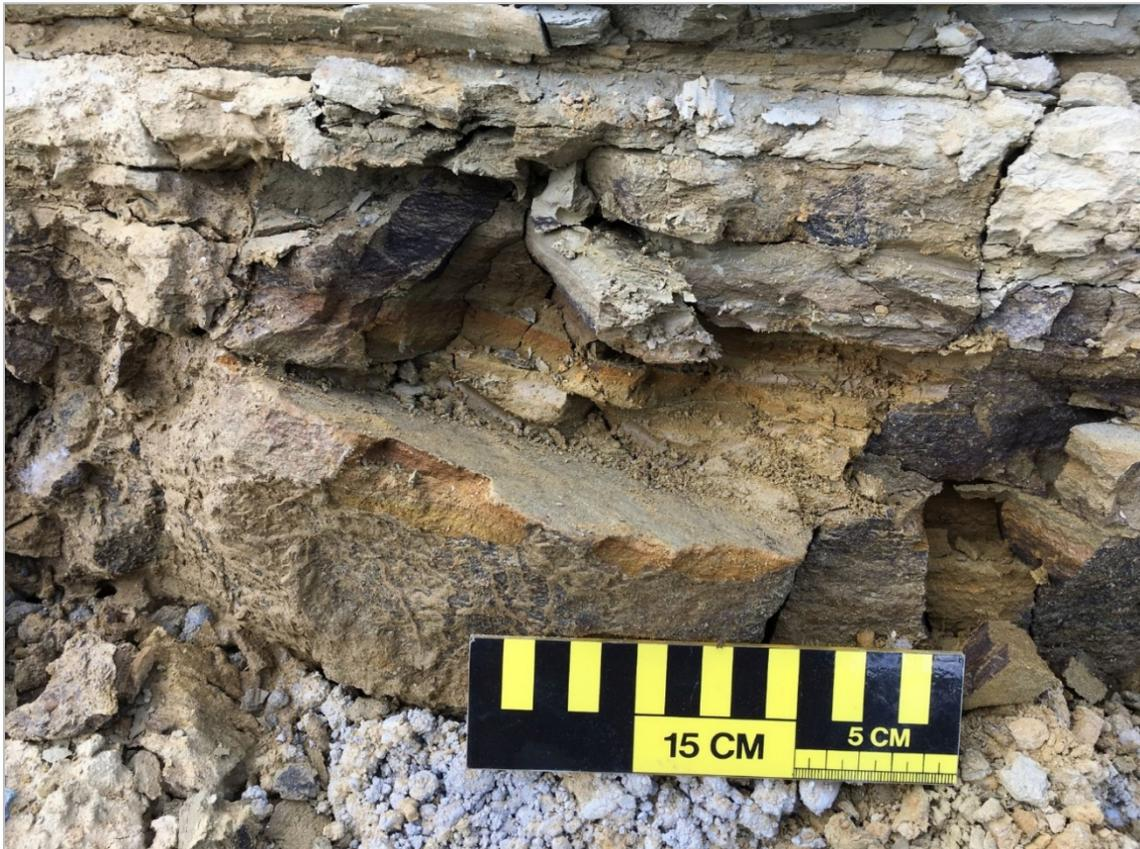
Abb. 2.2.1.18.: „Baulos Kriechspur B50 bei Oberwart“: Unterschiedlich dick gebankte schluffig, tonige Lagen mit schwarzen Manganausfällungen (M. Peresson).
