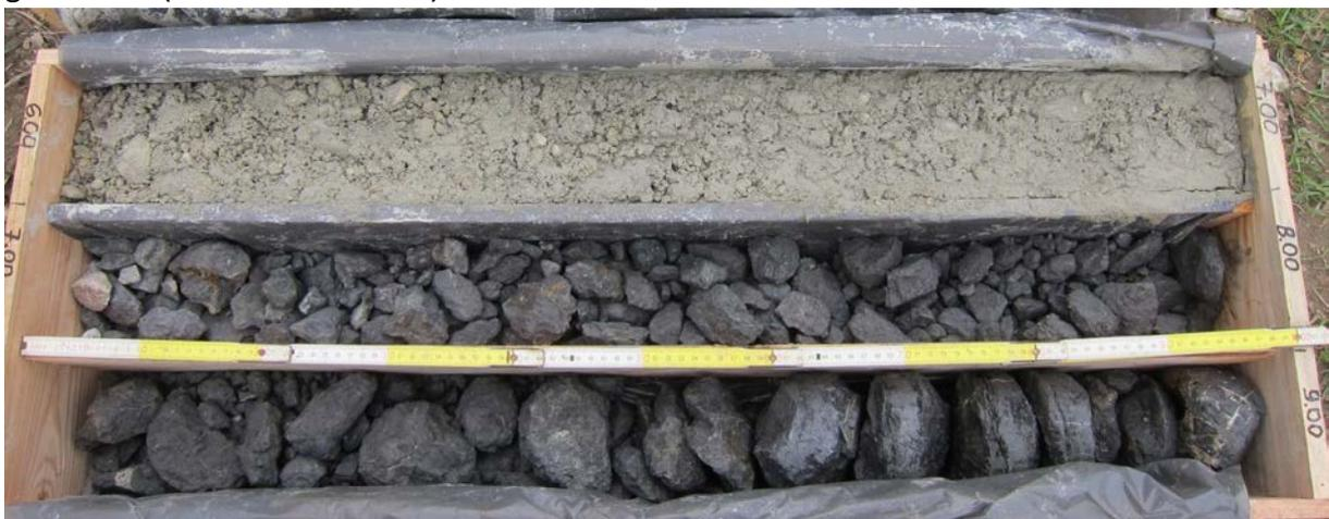
Abb. 2.1.1.22: EKB02a Wimpassing: 6,0-9,0m: Übergang holozäne-pleistozäne Kiese in mitteltriassische schwarze Dolomite (Foto: M. Peresson).
