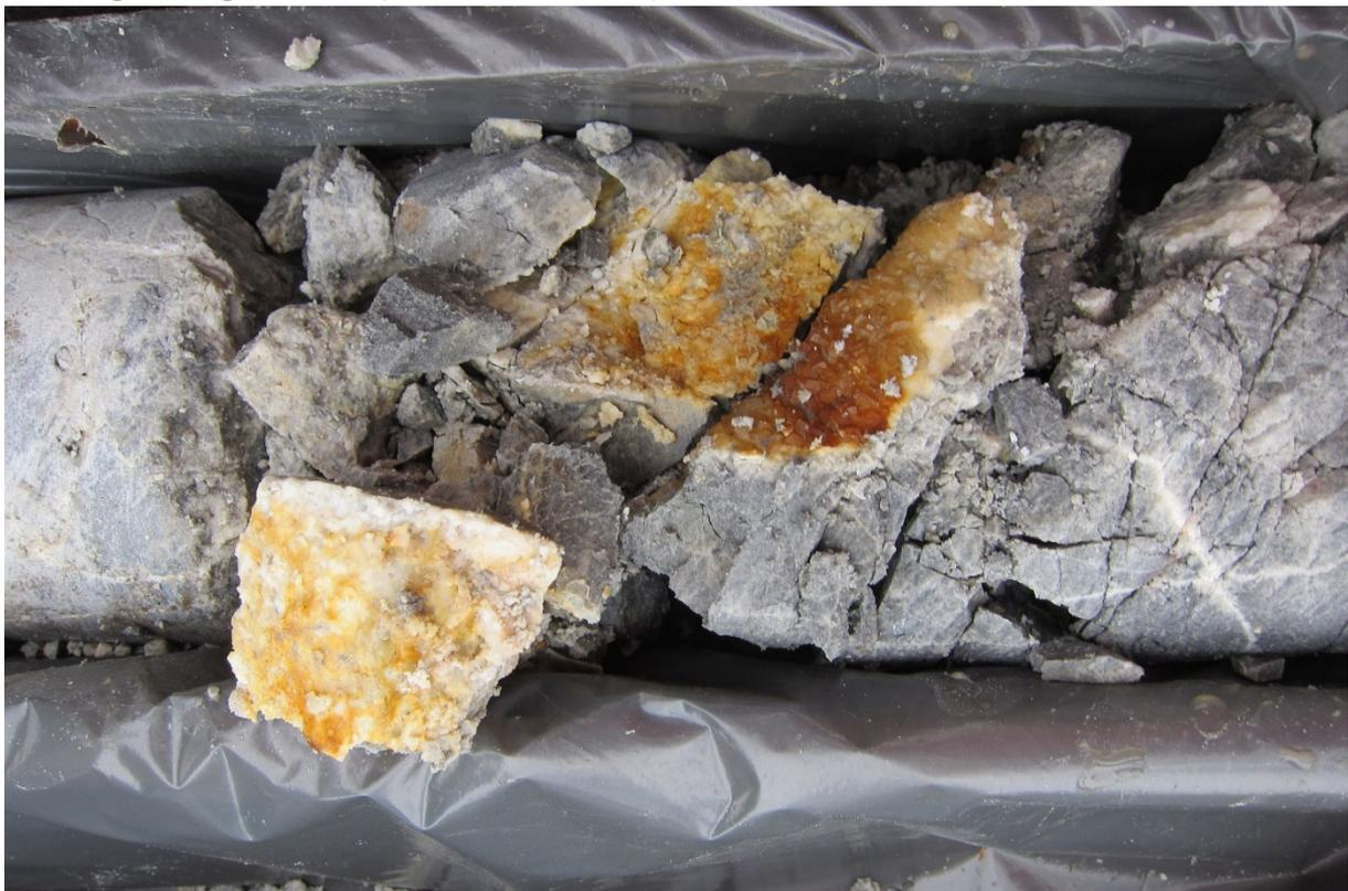
Abb. 2.1.1.29: EKB02a Wimpassing: Detailfoto bei 19,8m: Mitteltriassische schwarze Dolomite, stark geklüftet und tektonisiert (Foto: M. Peresson).
