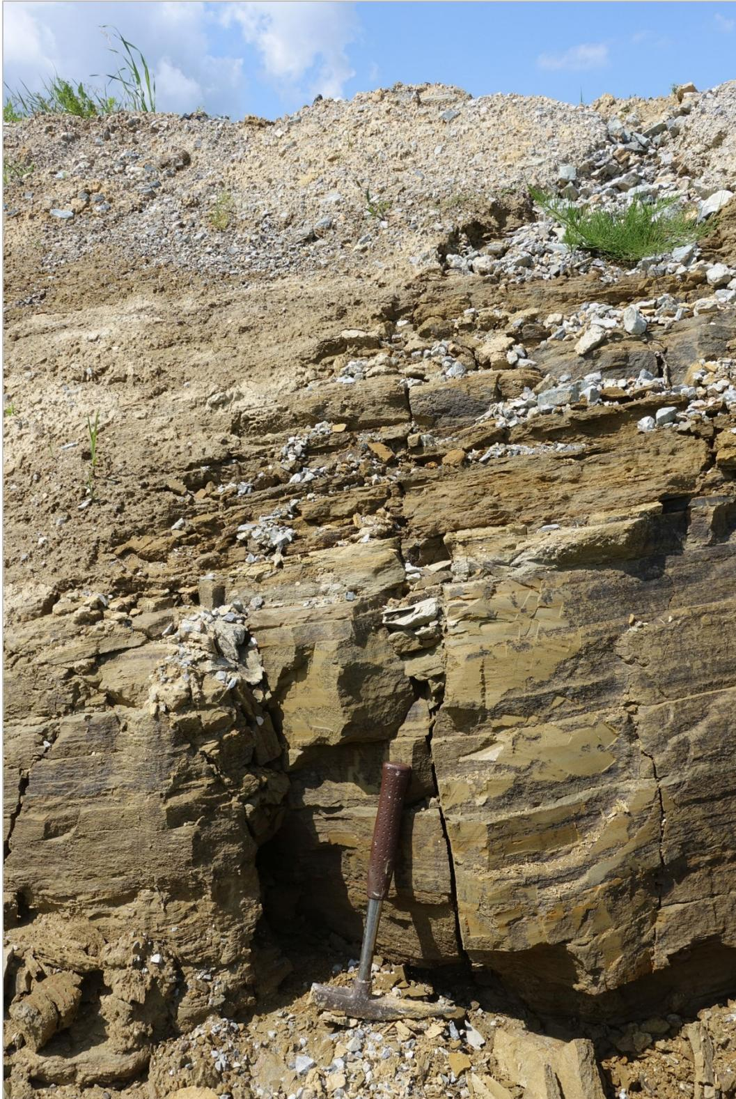
Abb. 2.2.1.20.: „Baulos Kriechspur B50 bei Oberwart“: Die besten Aufschlussverhältnisse finden sich im Bereich von Erosionsrinnen, wo eindeutig die Bankung der Schichten zu erkennen ist; im Bereich des Hammers ca. 50 cm mächtige Tonlage, intern fein laminiert (Foto: M. Peresson).
