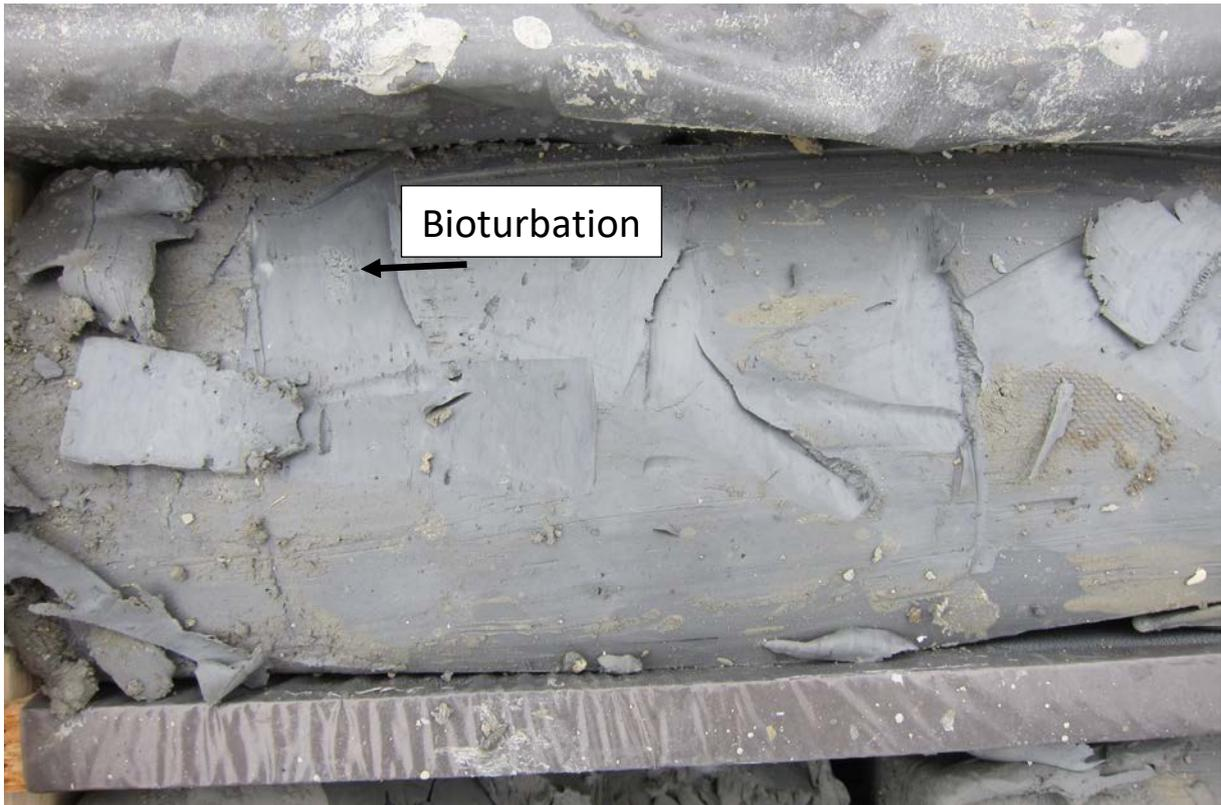
Abb. 2.1.1.38: EKB03 Wimpassing: 10,0-10,2m: Detailaufnahme der neogenen Schluffe und Tone mit Bioturbationsspuren (Sandlinsen) (Foto: M. Peresson).
