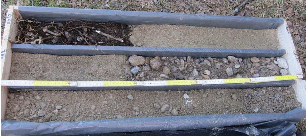
Abb. 2.1.1.15: EKB02 Wimpassing: 0,0-3,0m: Übergang Mutterboden in quartäre Sande und Kiese (Foto: M. Peresson).
