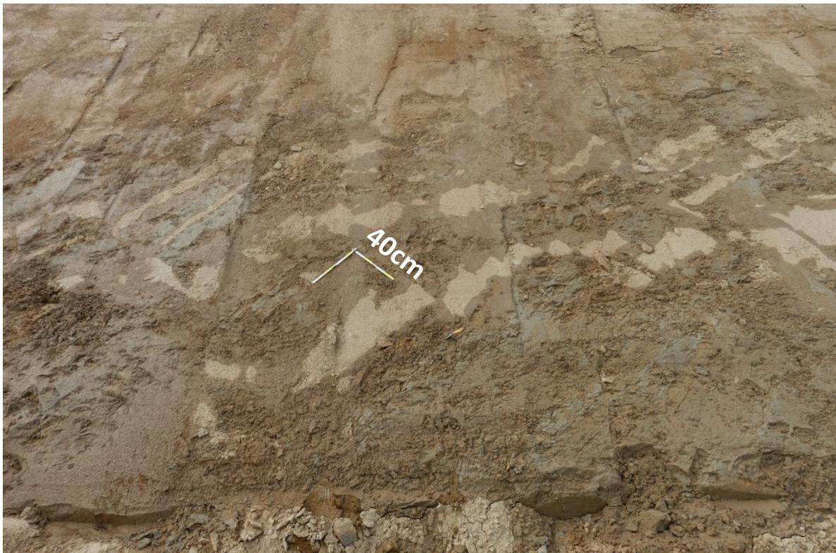
Abb. 2.2.1.32.: „Baulos Kriechspur B50 bei Oberwart“: Tektonisierter östlicher Abschnitt der Baustelle; Abschiebungsflächen (Foto: H. Peresson).
