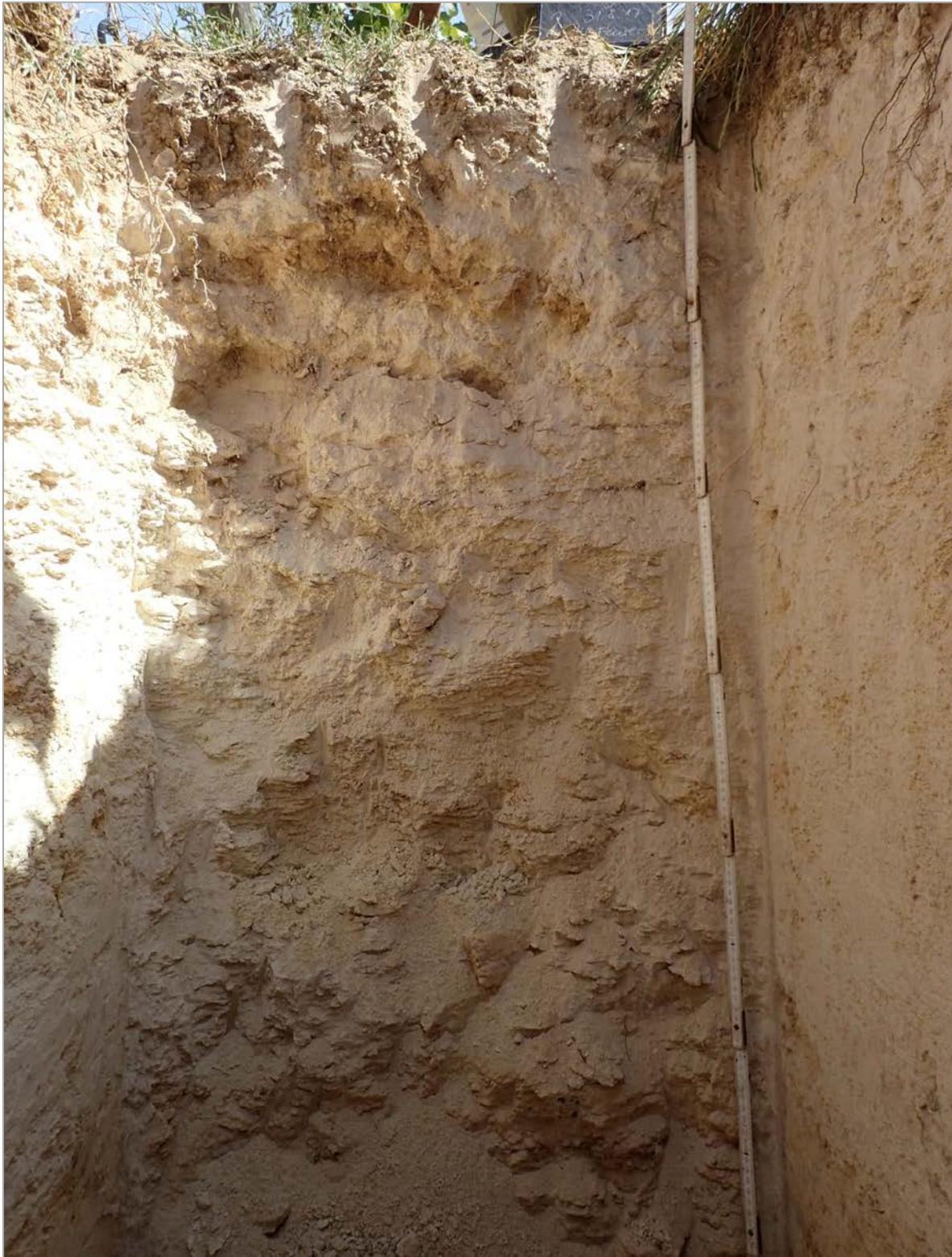
Abb. 3.1.6.: Schurf „Kleiner Feurer“ in St. Georgen: Im Hangenden ist ein dunkelbrauner Bodenhorizont erkennbar; im Liegenden sind weiße, teils gebankte Kalksandsteine in Leithakalkfazies aufgeschlossen (Foto: G. Posch-Trözmüller).
