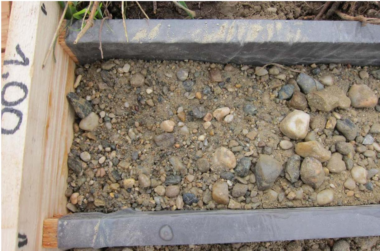
Abb. 2.1.1.36: EKB03 Wimpassing: 1,0-1,2m: Detailaufnahme des Komponentenspektrums der holozänen-pleistozänen Kiese (Foto: M. Peresson).
