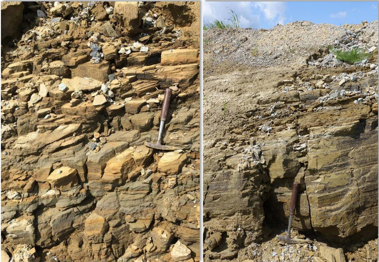
Abb. 2.2.1.55.: Baustelle entlang der B50 bei Oberwart: Klüfte in kompetenten Sandsteinlagen, grundsätzlich senkrecht zur leicht einfallenden Schichtung (Foto: M. Peresson).
