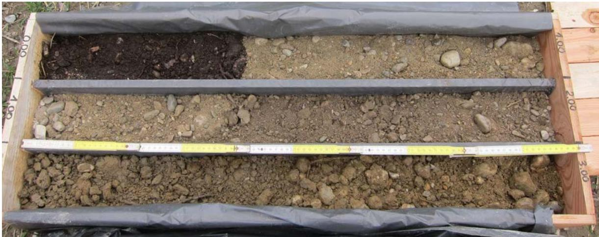
Abb. 2.1.1.20: EKB02a Wimpassing: 0,0-3,0m: Übergang dunkelbraune Erde (Mutterboden) in holozäne-pleistozäne Sande und Kiese (Foto: M. Peresson).
