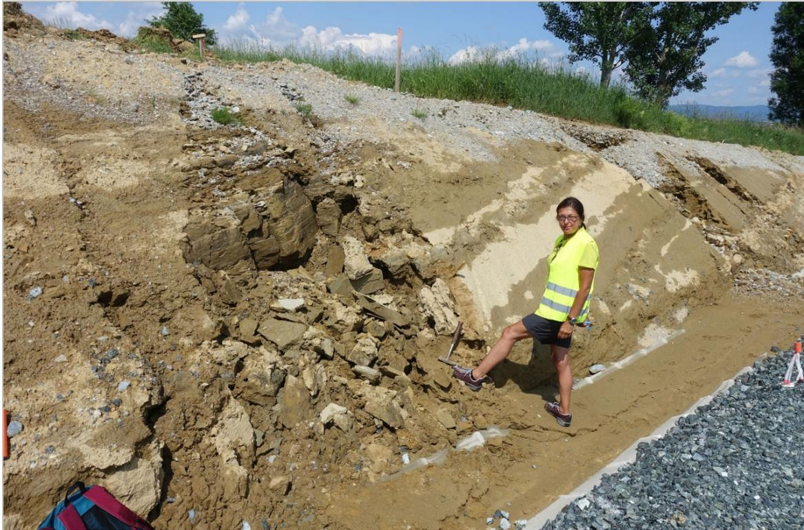
Abb. 2.2.1.15.: „Baulos Kriechspur B50 bei Oberwart“: Im Bereich der Erosionsrinnen sind Schichtung und Klüftung der Sedimente zumeist am besten ausgebildet (Foto: H. Peresson).
