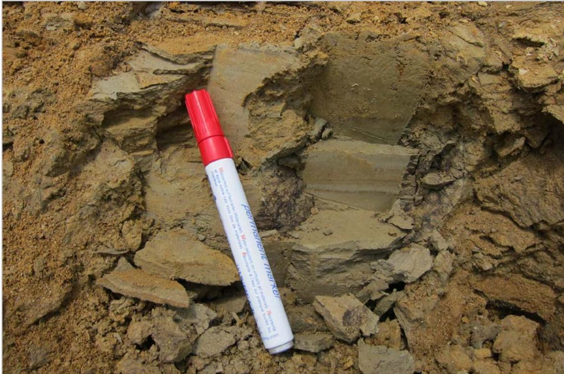
Abb. 2.2.1.17.: „Baulos Kriechspur B50 bei Oberwart“: Detailfoto: Feine Lamination innerhalb der Tonlagen erkennbar (Stillwasserbereich) (Foto: M. Peresson).
