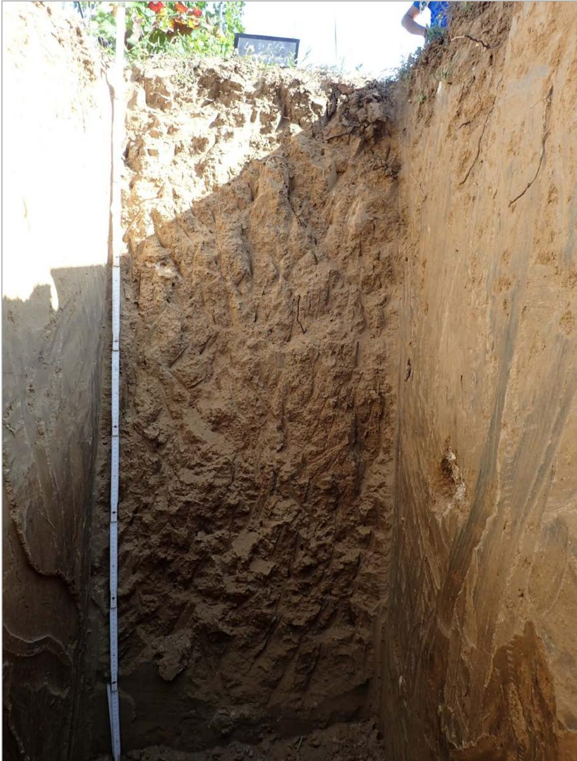
Abb. 3.1.10.: Schurf „Schneiderteil-Reimer“ in St. Georgen: Im Liegenden des hellbraunen Bodenhorizontes sind rötlichbraune sandige bis tonige Schluffe aufgeschlossen; bis in 1,1m Tiefe treten vereinzelt Karbonatausfällungen auf (Foto: G. Posch-Trözmüller).
