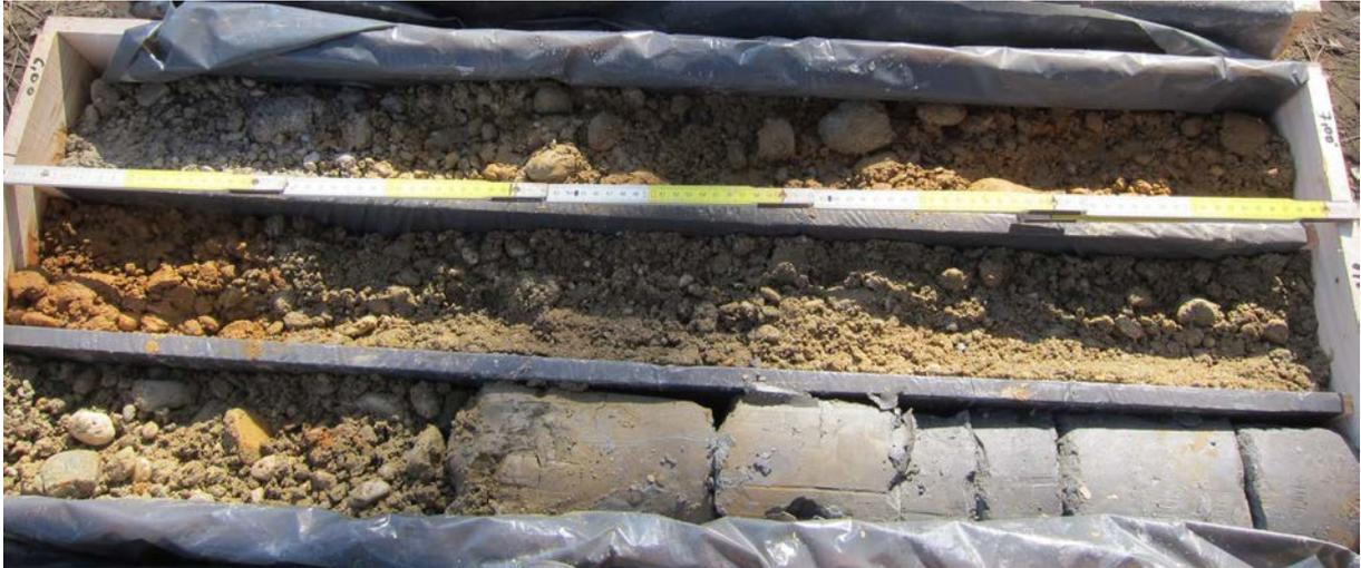
Abb. 2.1.1.10: EKB01 Wimpassing: 6,0-9,0m: Übergang quartäre Kiese (8,3m) in neogene Sedimente (Foto: M. Peresson).
