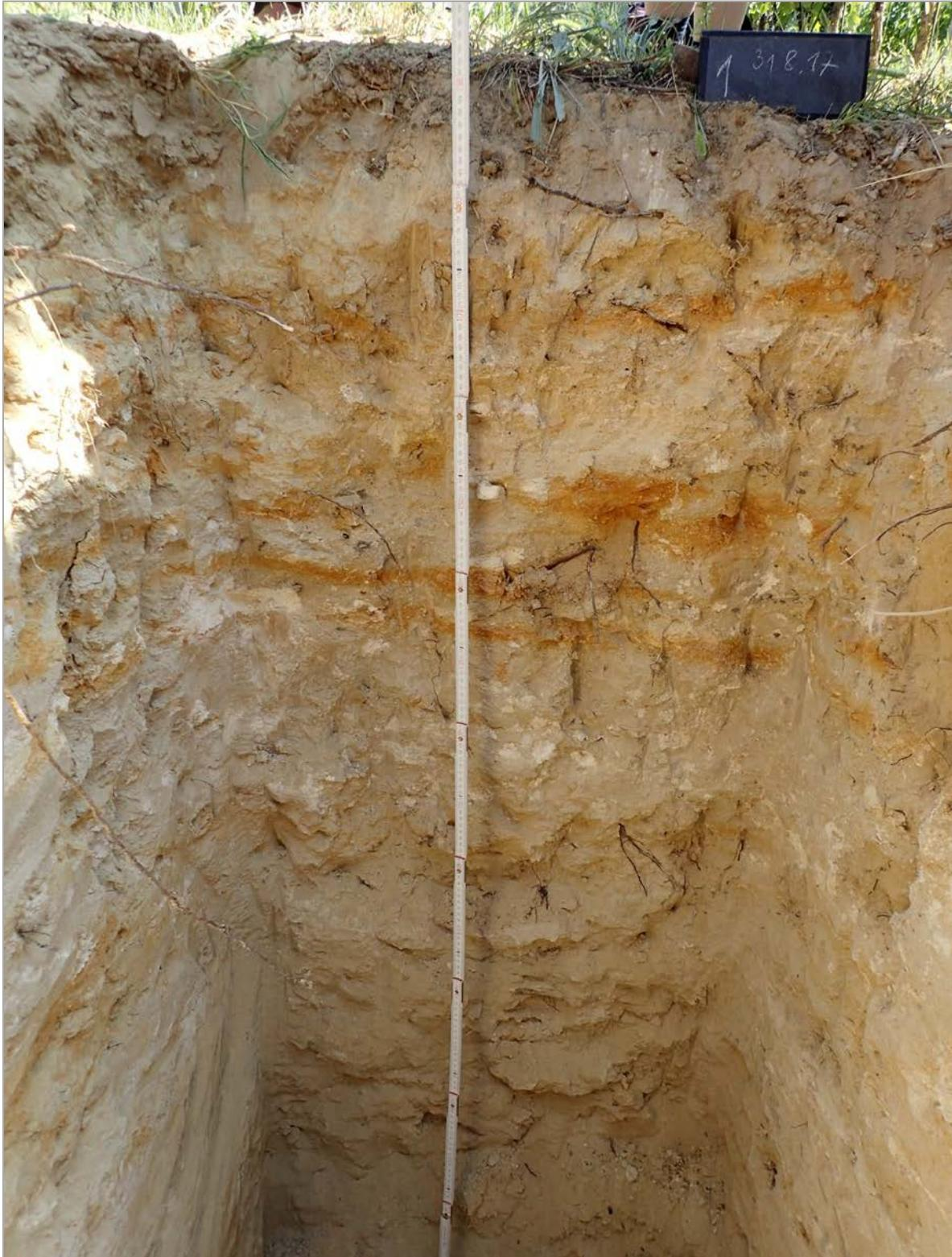
Abb. 3.1.8.: Schurf „Kraakauer“ in St. Georgen: Im Liegenden des hellbraunen Bodenhorizontes sind schluffig, tonige Feinsande aufgeschlossen; bis in 1m Tiefe ist das Sediment stark verwurzelt und es treten Kalk- und Eisenoxidausfällungen auf (Foto: G. Posch-Trözmüller).
