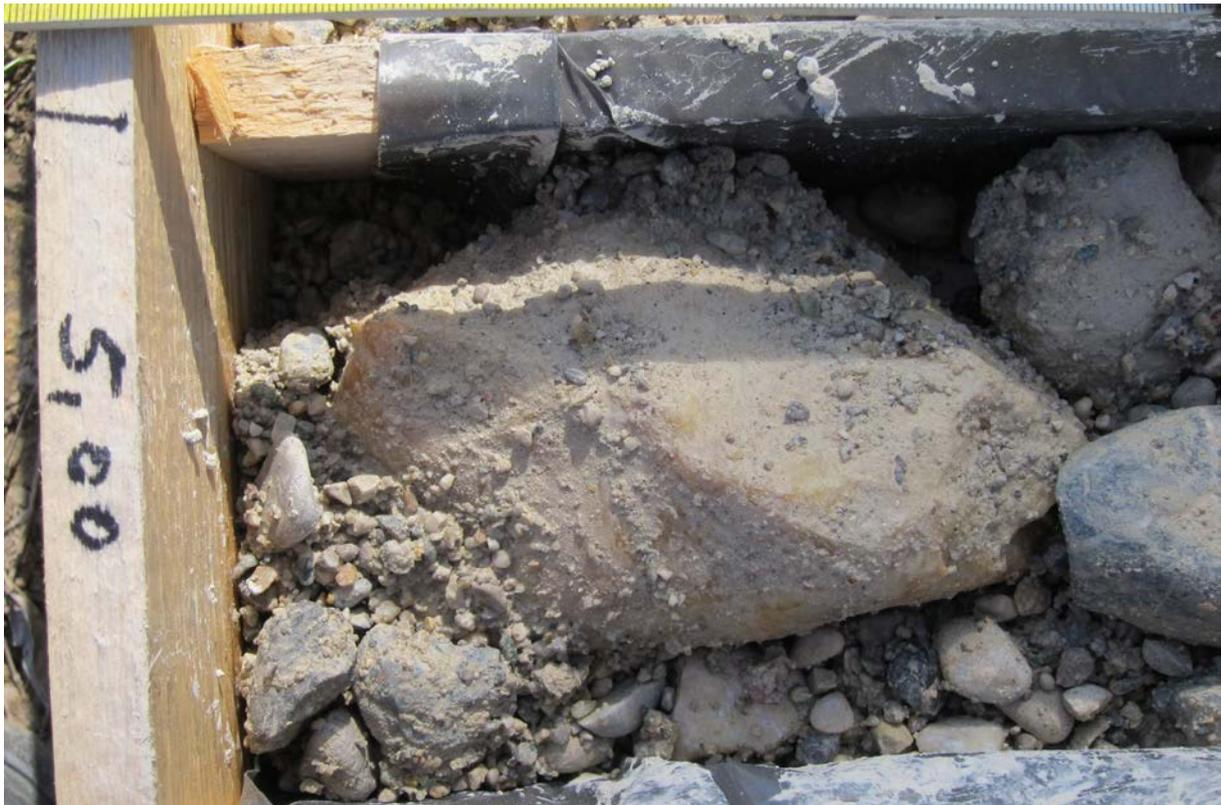
Abb. 2.1.1.12: EKB01 Wimpassing: 5,0m: Quartäre Kiese in sandig, schluffiger Matrix (Foto: M. Peresson).
