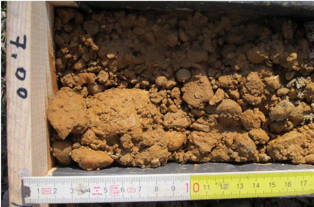
Abb. 2.1.1.14: EKB01 Wimpassing: 7,0m: ?Pliozäne Kiese mit rötlicher sandig, schluffiger Matrix (Foto: M. Peresson).
