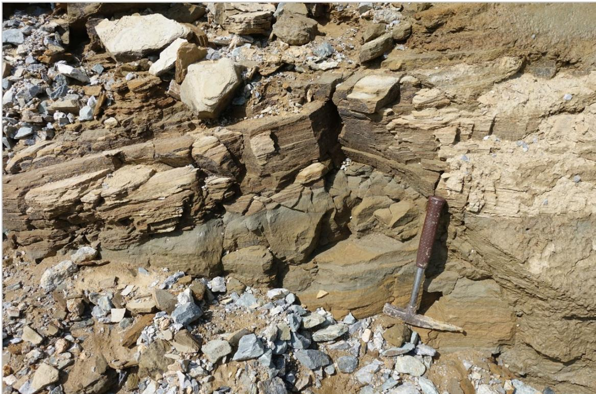
Abb. 2.2.1.16.: „Baulos Kriechspur B50 bei Oberwart“: Wechsellagerungen von tonigen grauen Schluffen und braunen, laminierten Feinsanden (Foto: M. Peresson).
