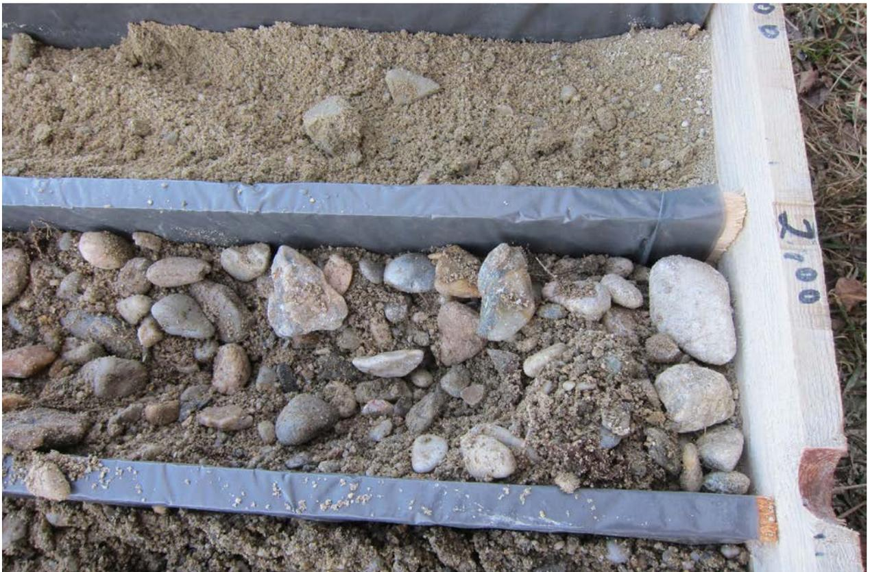
Abb. 2.1.1.18: EKB02 Wimpassing: 1,8-2,0m: Detailaufnahme der quartären Kiese; Quarz- und Karbonatkomponenten zumeist gut gerundet (Foto: M. Peresson).
