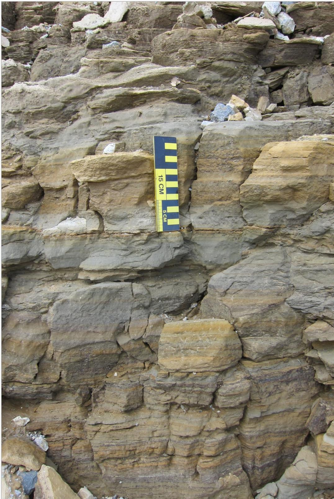
Abb. 2.2.1.23.: „Baulos Kriechspur B50 bei Oberwart“: Wechsellagerung von sandigen (braun) und tonigen (grau-violett) Abschnitten; ausgeprägte Klüftung in den Sedimenten erkennbar (Foto: M. Peresson).
