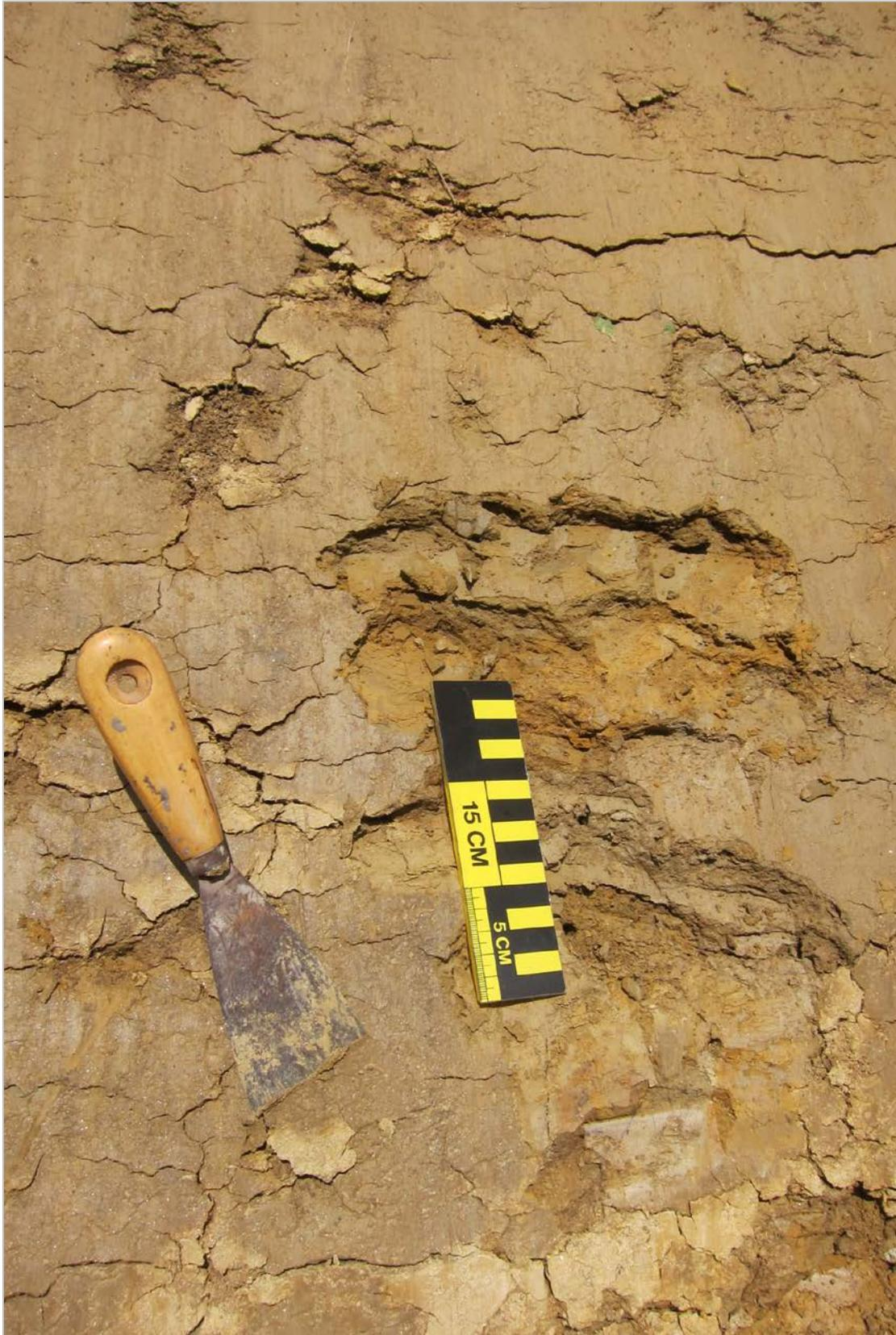
Abb. 2.2.1.11.: „Baulos Kriechspur B50 bei Oberwart“: Ungestörter Bereich am westlichen Startpunkt der Baustelle. Limonitische Beläge an den Schichtflächen der schluffig, tonigen Sedimente (Foto: M. Peresson).
