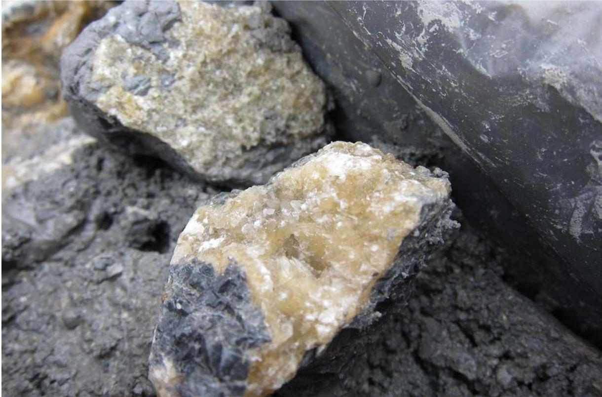
Abb. 2.1.1.30: EKB02a Wimpassing: Detailfoto zwischen 14-15,0m: Mitteltriassische schwarze Dolomite mit Kalzit gefüllten Klüften (Foto: M. Peresson).
