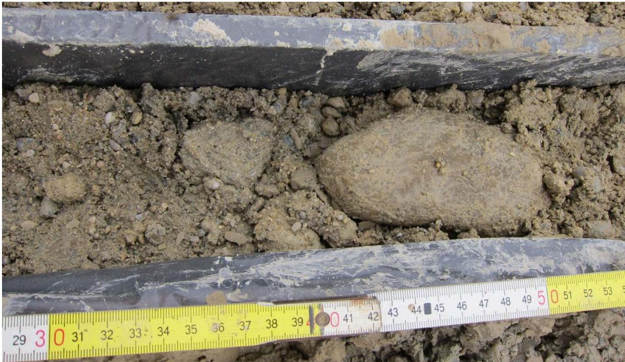
Abb. 2.1.1.28: EKB02a Wimpassing: Detailfoto bei 4,5m: Holozäne-Pleistozäne Kiese in schluffig, sandiger Matrix (Foto: M. Peresson).
