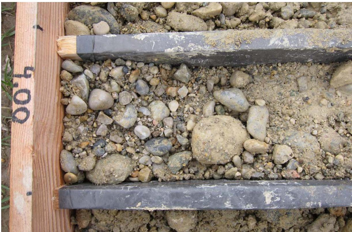
Abb.2.1.1.37: EKB03 Wimpassing: 4,0-4,2m: Detailaufnahme des Komponentenspektrums der holozänen-pleistozänen Kiese (Foto: M. Peresson).
