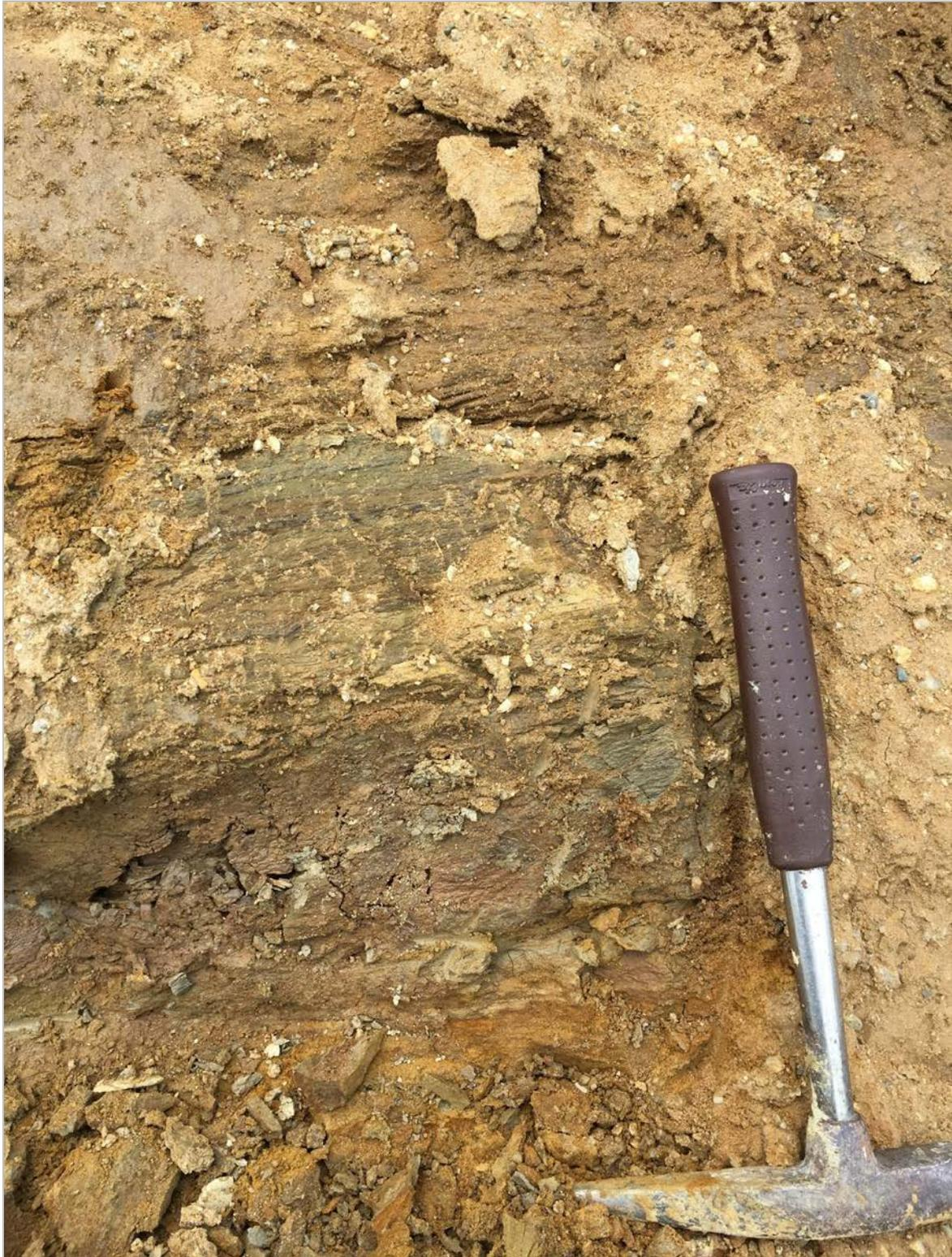
Abb. 2.2.1.24.: „Baulos Kriechspur B50 bei Oberwart“: Ungestörter Bereich der Baustelle; Bereichsweise rötlich-violette Verfärbung der Tonlagen zu beobachten (Foto: M. Peresson).
