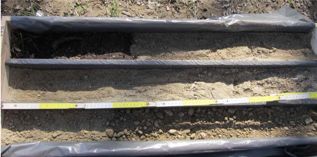
Abb. 2.1.1.8: EKB01 Wimpassing: 0,0-3,0m: Übergang Mutterboden in quartäre Sande und Kiese (Foto: M. Peresson).
