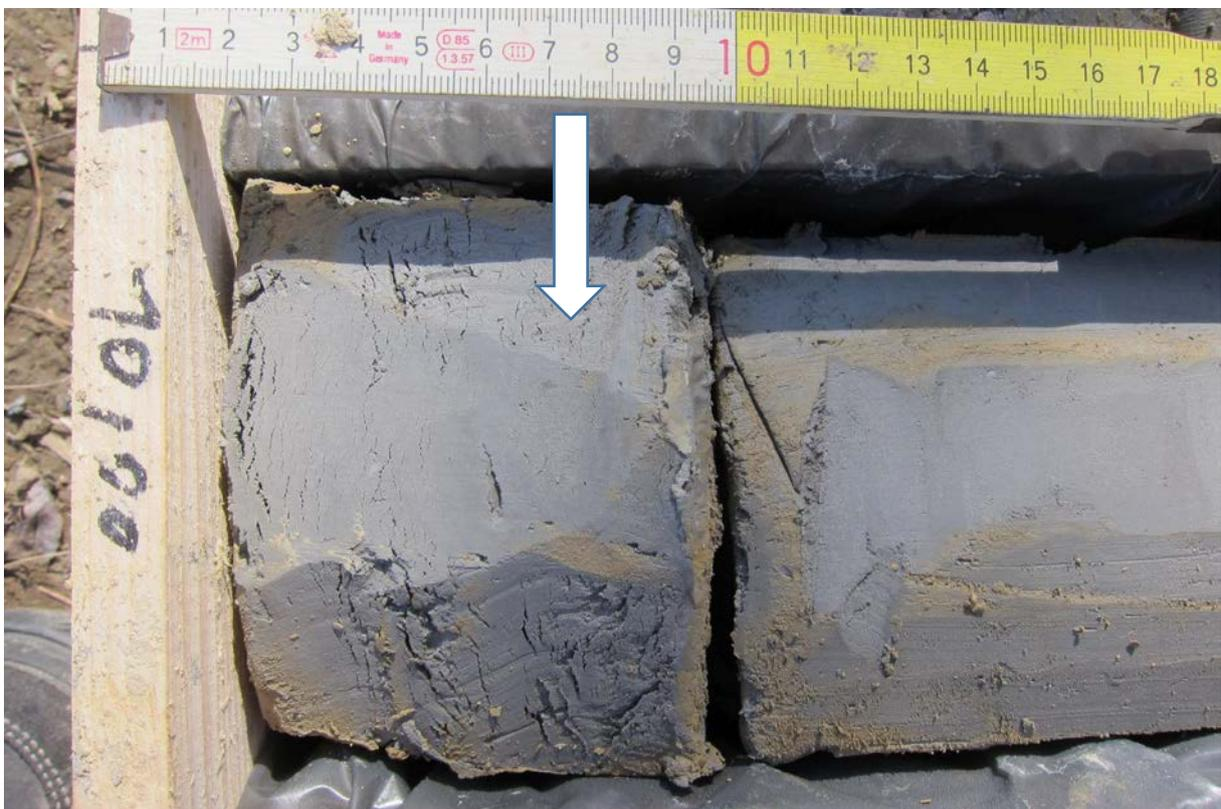
Abb. 2.1.1.13: EKB01 Wimpassing: 10,0m: Neogene Sedimente mit Bioturbationsspuren (verwühlter Sandanteil) (Foto: M. Peresson).
