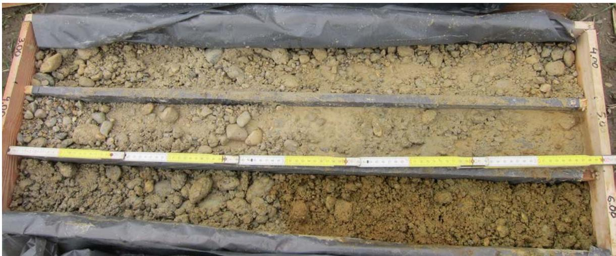
Abb. 2.1.1.32: EKB03 Wimpassing: 3,0-6,0m: Braune holozäne-pleistozäne Kiese in schluffig, sandiger Matrix im Übergang zu rötlichen pliozänen? Kiesen und Sanden (Foto: M. Peresson).
