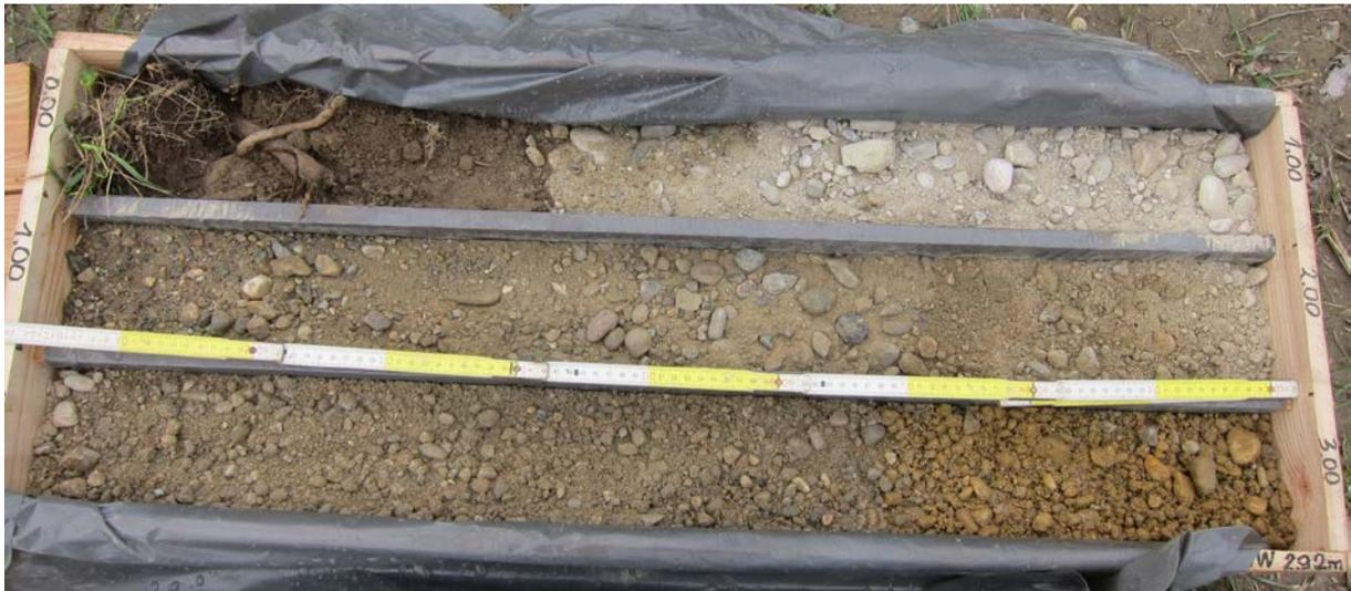
Abb. 2.1.1.31: EKB03 Wimpassing: 0,0-3,0m: Holozäne-pleistozäne Kiese in schluffig, sandiger Matrix (Foto: M. Peresson).
