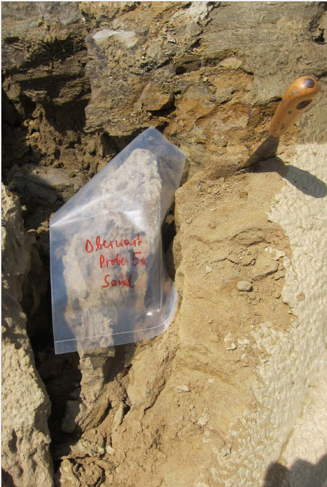
Abb. 2.2.1.37.: „Baulos Kriechspur B50 bei Oberwart“: Probenahmepunkt für die „Proben 3a und b“ an der Basis der geschichteten Ablagerungen (Foto: M. Peresson).
