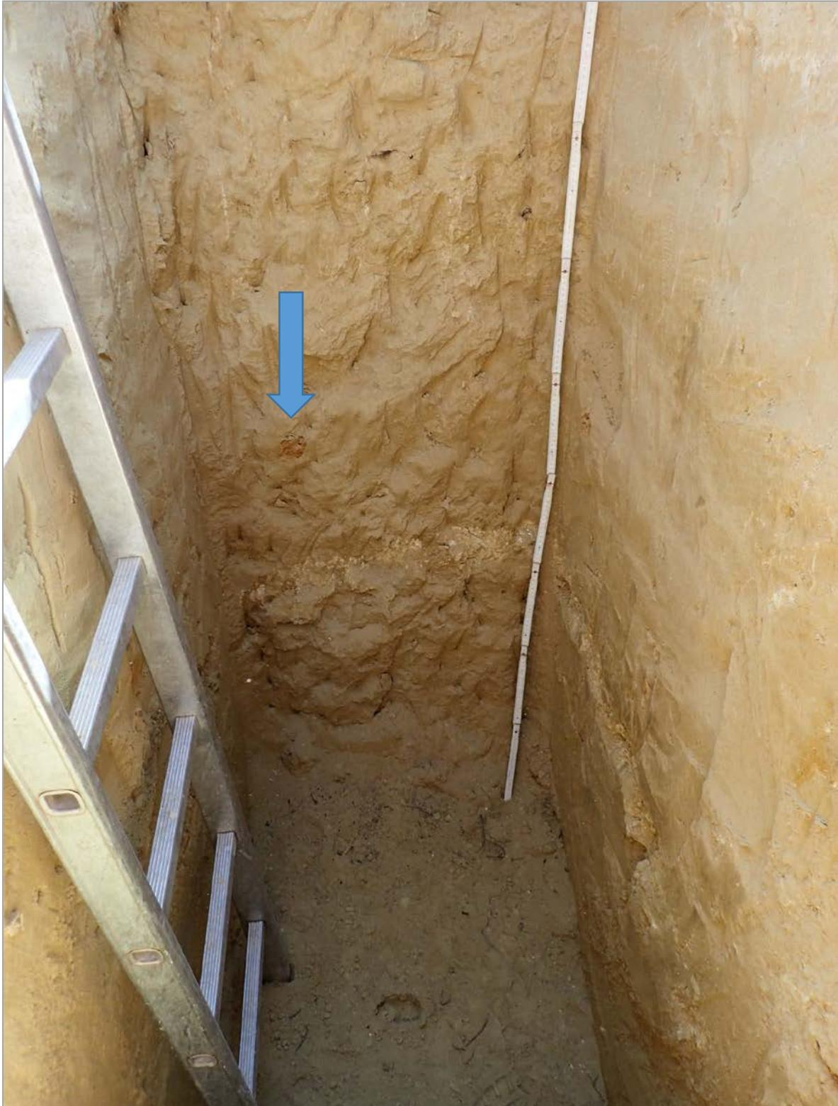
Abb. 3.1.4.: Schurf „Großer Feurer“ in St. Georgen: Ockergelbe sandig, tonige Schluffe (Löss) mit weißem durchgehendem Lösskindelhorizont und rötlichen, limonitischen Ausfällungen (siehe Pfeil) (Foto: G. Posch-Trözmüller).
