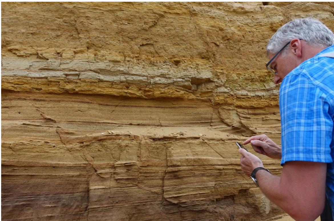
Abb. 2.2.1.46.: Sandgrube in Oberwart, gegenüber McDonalds beim Kreisverkehr: Konjugierte Störungssets innerhalb der Sandlagen (Foto: M. Peresson).
