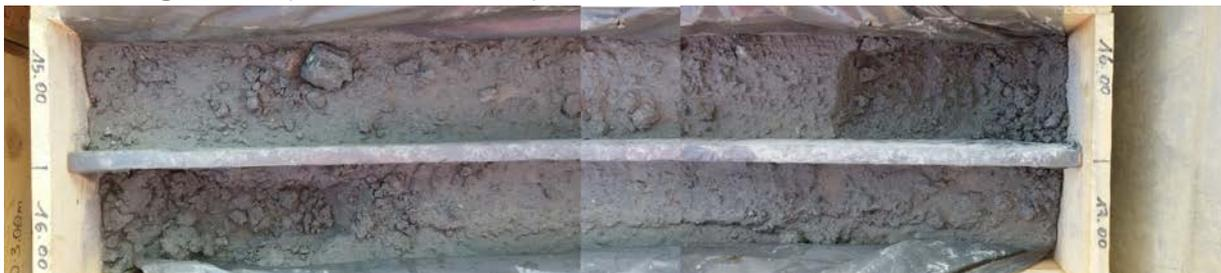
Abb. 2.1.1.25: EKB02a Wimpassing: 15,0-17,0m: Mitteltriassische schwarze Dolomite, fein zerrieben (tektonisiert?) (Foto: G. Bieber).
