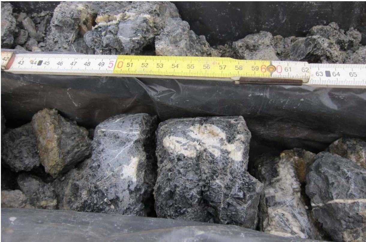
Abb. 2.1.1.27: EKB02a Wimpassing: Detailfoto bei 14,5m: Mitteltriassische schwarze Dolomite, stark geklüftet und tektonisiert (Foto: M. Peresson).
