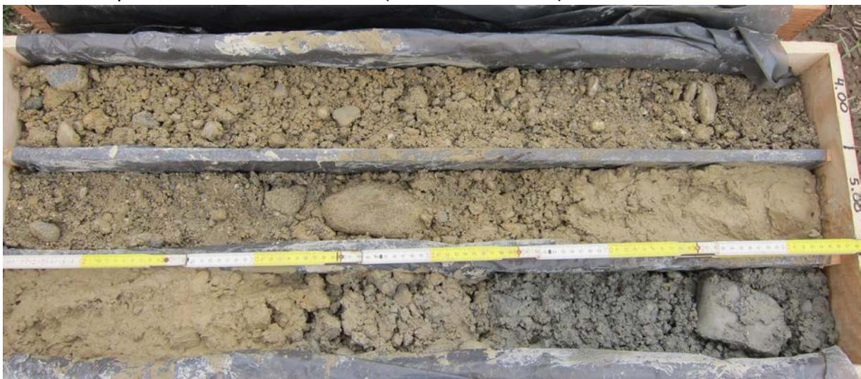
Abb. 2.1.1.21: EKB02a Wimpassing: 3,0-6,0m: Holozäne-pleistozäne Kiese in schluffig, sandiger Matrix (Foto: M. Peresson).
